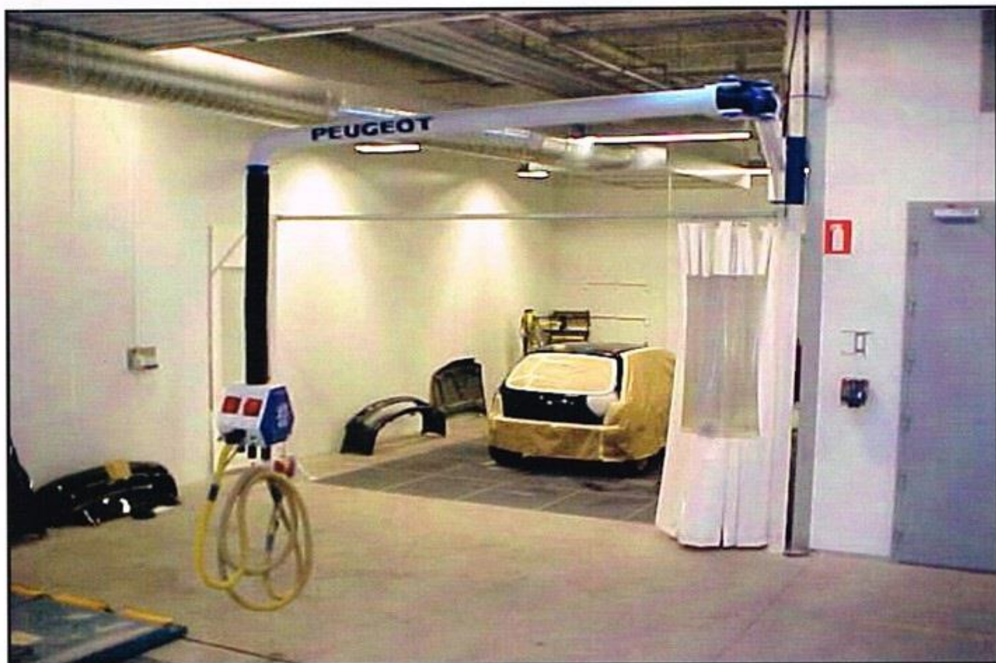
MFB 520 monteret på 6,5 meter svingarm
